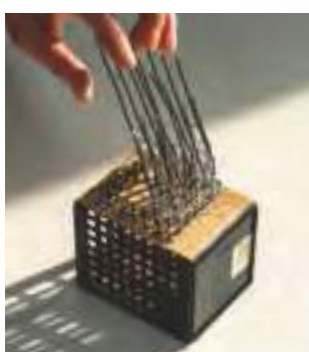
難易度の高い柱部分の施工手順・方法を検討するために、行廣社長が手づくりした縮尺模型。
